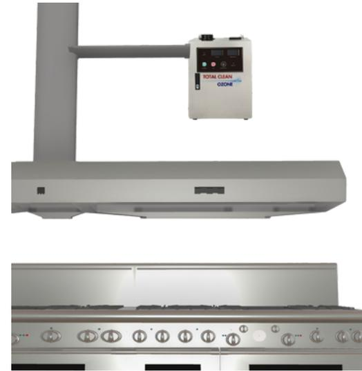
2. La sortie d'ozone du générateur est connectée au conduit d'évacuation après la hotte d'extraction. L'ozone a besoin d'un temps de contact minimum avec l'odeur pour pouvoir changer sa structure et la détruire. Deux secondes est le timing idéal.
